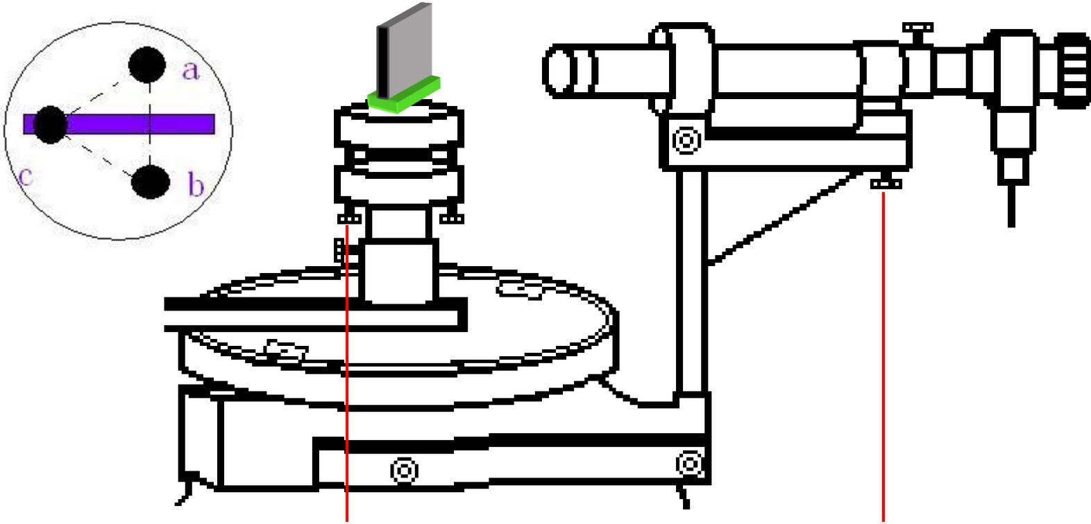
② 调节载物盘水平调节螺钉a和b或望远镜俯仰调节螺钉
